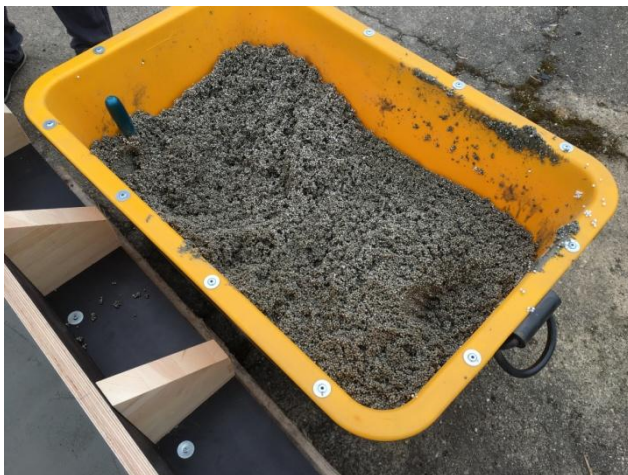
Abbildung 1 Frischbeton mit EPS
